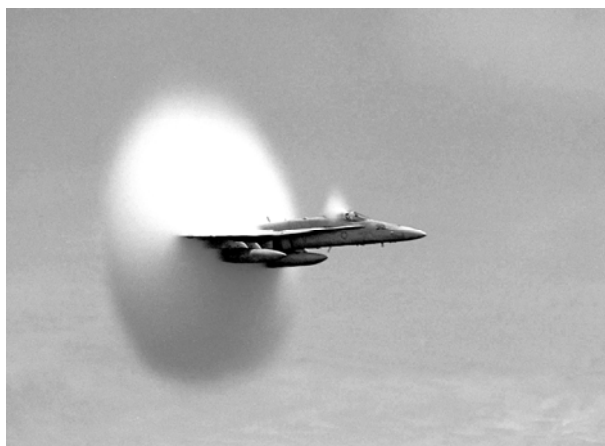
Рис. 8.2. Образование облака на фронте ударной волны при превышении самолетом скорости звука
