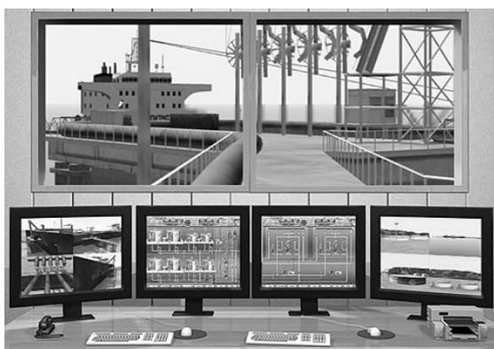
*Рис. 8. Вид тренажера оператора нефтетерминала*
