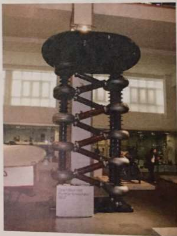
Рис. 6.9. Общий вид многоступенчатого каскадного генератора постоянного тока для ускорителя заряженных частиц
