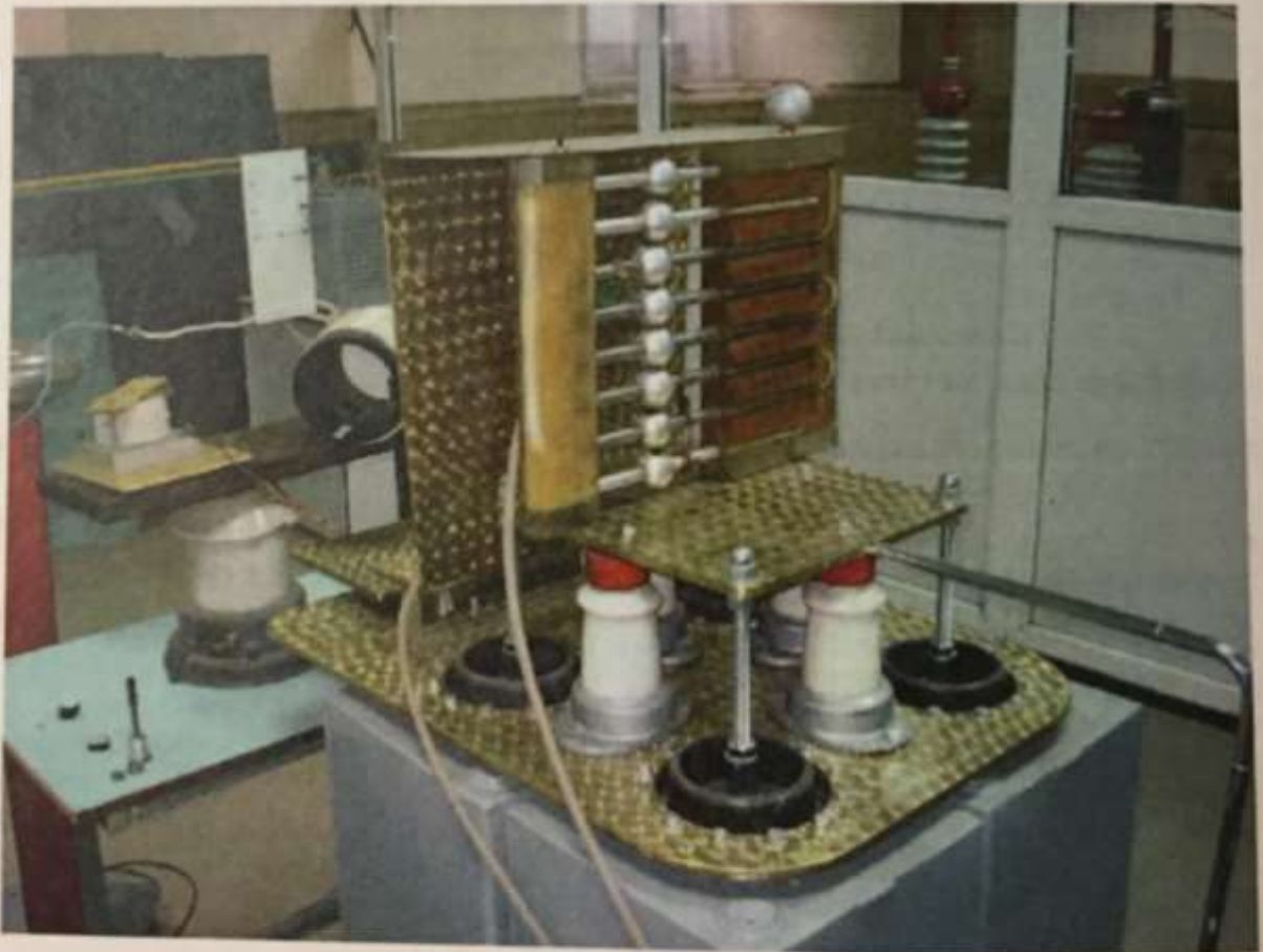
Рис. 7.5. Внешний вид генератора импульсов тока
