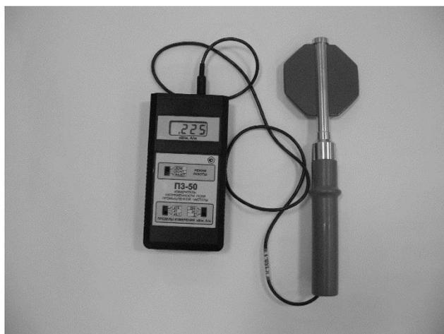
*Рис. 1. Измеритель напряженности поля промышленной частоты с антенной-преобразователем НЗ-50*
