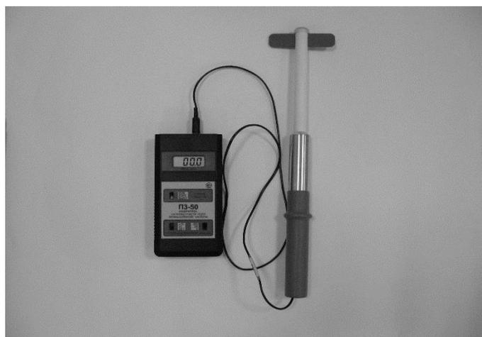
*Рис. 1. Измеритель напряженности поля промышленной частоты с антенной-преобразователем ЕЗ-50*
