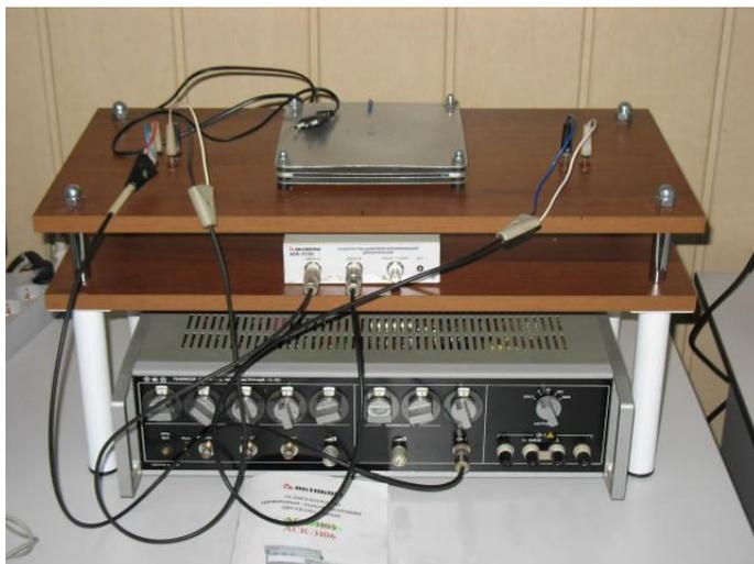
*Рис. 6. Общий вид лабораторной установки для исследования экранирующих свойств электромагнитных экранов.*
