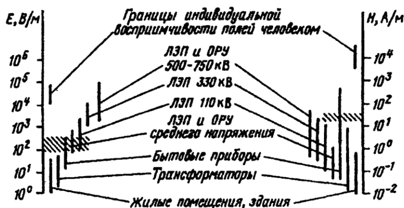
Рис. 7.1. Характерные напряженности электрических и магнитных полей промышленной частоты
