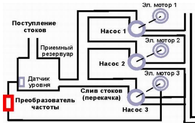
Рис. 6.12. Применение частотно-регулируемого электропривода для канализационной насосной станции
