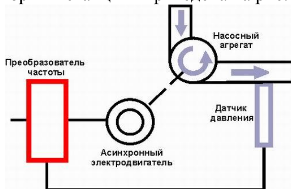
Рис. 6.11. Схема частотно-регулируемого асинхронного электропривода на водонапорных станциях
