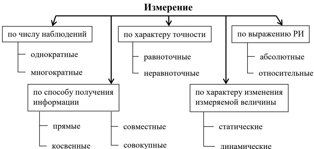
*Рис. 2.3. Классификация измерений*
