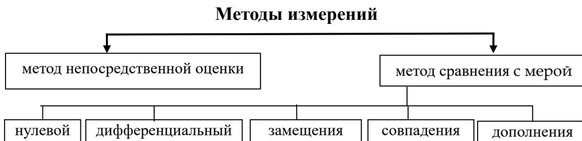
Рис. 7.4. Классификация методов измерений
