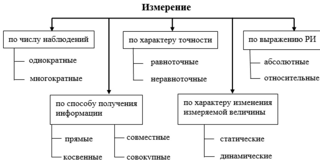
*Рис. 2.3. Классификация измерений*
