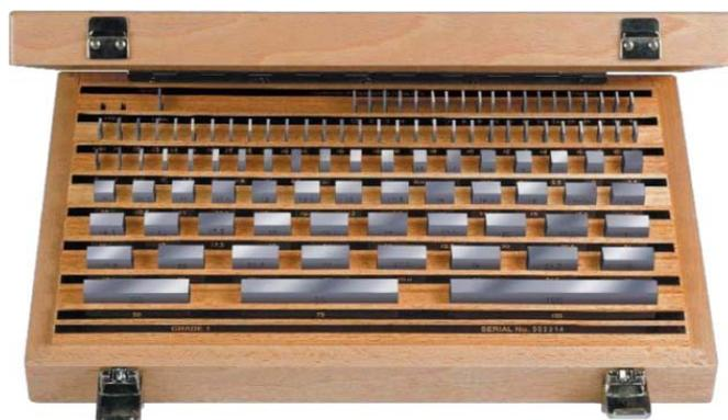
Рис. 8.1. Набор плоскопараллельных концевых мер
