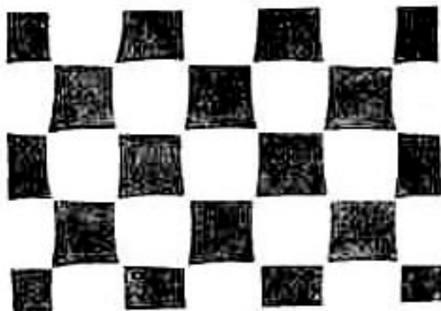
Рис.5.6.Геометрические искажения изображения, вызванные особенностью работы передающей трубки типа суперортискон.
