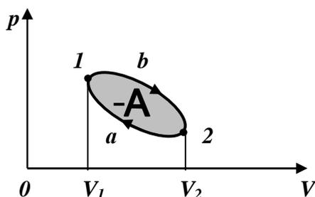
Рис. 139. Обратный цикл
