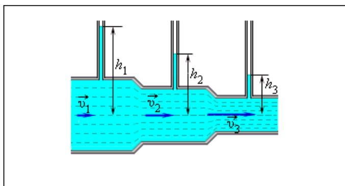
Рис. 96. Измерение давления в потоке жидкости с помощью манометров:  $v_1 < v_2 < v_3$ ;  $h_1 > h_2 > h_3$
