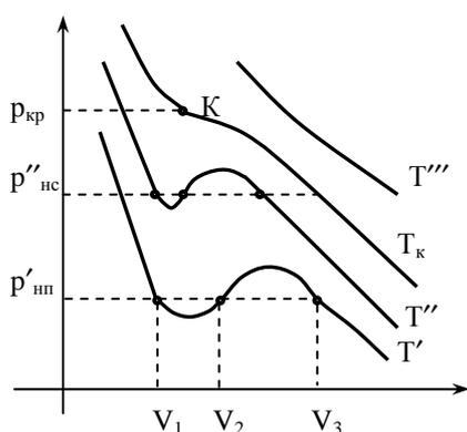
Рис. 155. Изотермы Ван-дер-Ваальса
