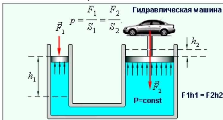
Рис. 91. Гидравлический подъёмник
