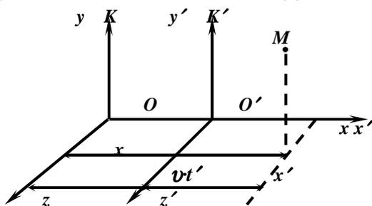
Рис. 103. Системы отсчёта  $K$  и  $K'$
