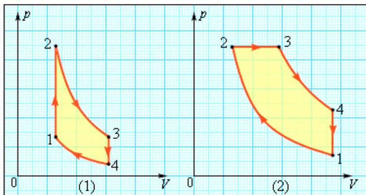
Рис. 142. Циклы карбюраторного двигателя внутреннего сгорания (1) и дизельного двигателя (2)
