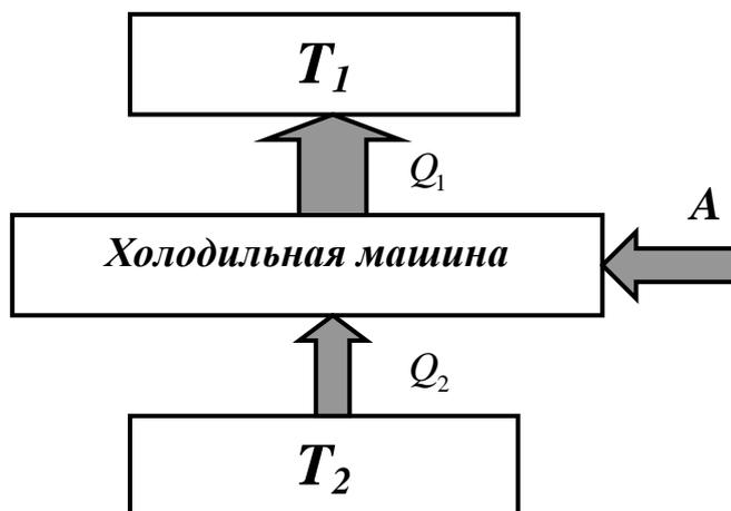
Рис. 141. Принцип работы холодильной машины
