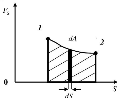
Рис. 51. Геометрический смысл выражения для работы
