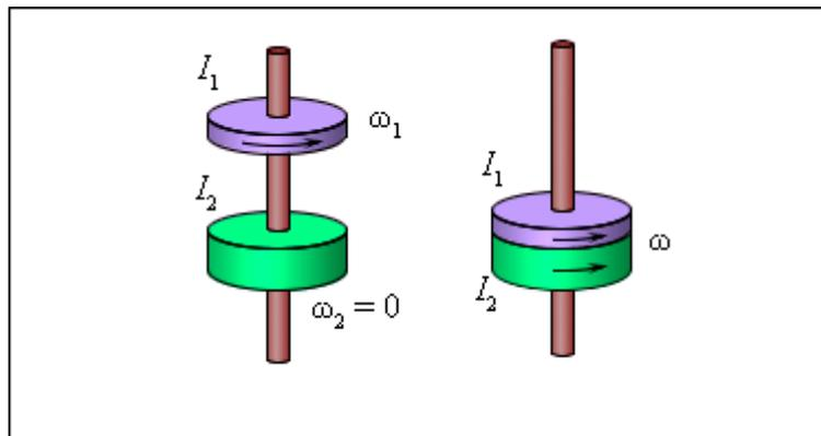
Рис. 76. Неупругое вращательное столкновение двух дисков
