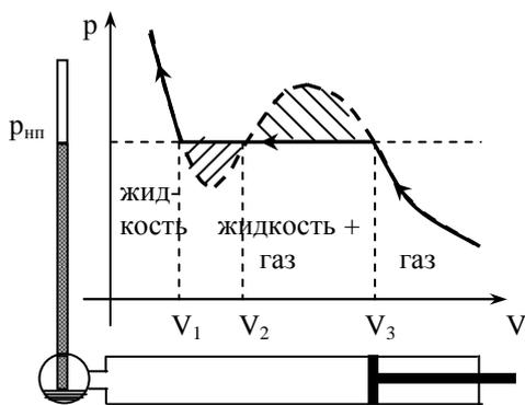
Рис. 152. График  $p=f(V)$
