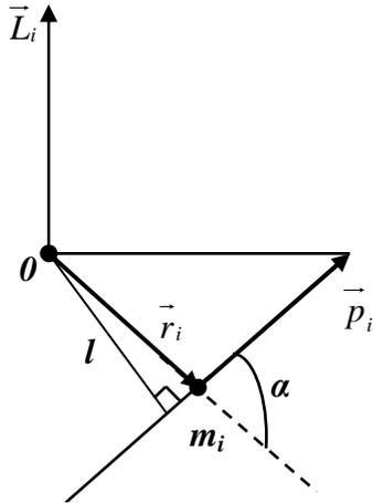
Рис. 74. К определению направления  $\vec{L}_i$
