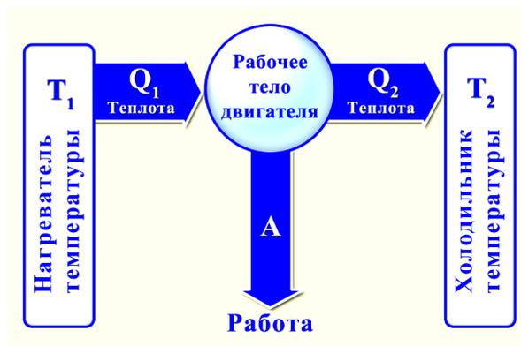
Рис. 140. Принцип работы теплового двигателя
