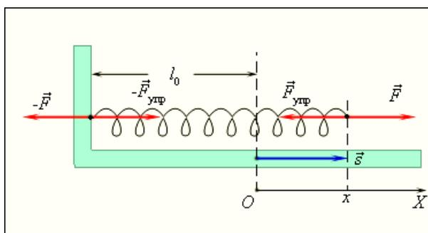
Рис. 52. Растянутая пружина
