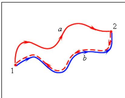
Рис. 54. Работа консервативной силы  $A_{1a2} = A_{1b2}$
