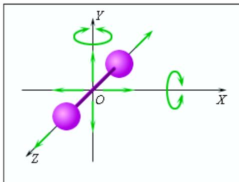
Рис. 130. Модель двухатомной молекулы. Точка  $O$  совпадает с центром масс молекулы
