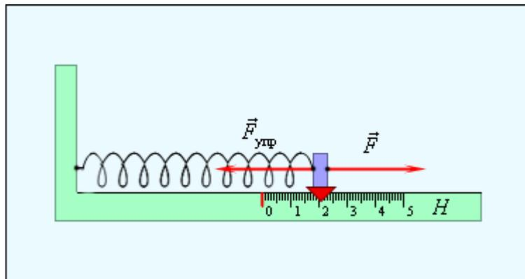
Рис. 28. Измерение силы по растяжению пружины
