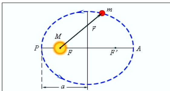
Рис. 80. Эллиптическая орбита планеты массой  $m \ll M$ .
