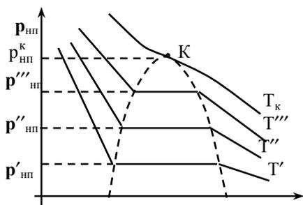
Рис.153. Изотермы Ван-дер-Ваальса
