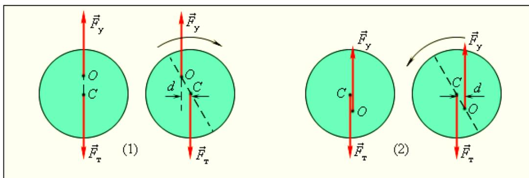
Рис. 67. Устойчивое (1) и неустойчивое (2) равновесие однородного круглого диска, закрепленного на оси  $O$
