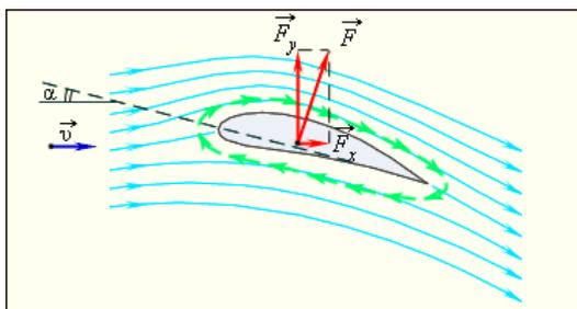
Рис. 101. Линии тока при обтекании крыла самолета и возникновение подъемной силы;  $\alpha$  – угол атаки
