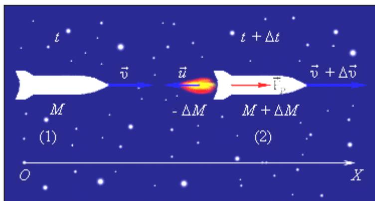
Рис. 49. Ракета, движущаяся в свободном пространстве (без гравитации)
