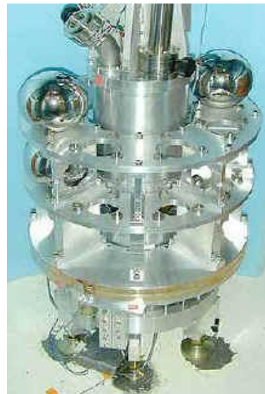
Рис. 1.8.4. Современные торсионные весы, используемые для уточнения величины \gamma
