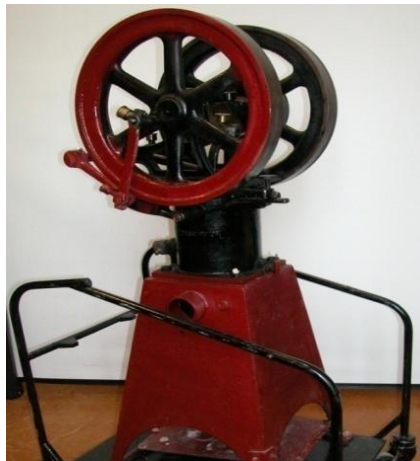
Рис. 3.2.8. Двигатель внешнего сгорания (двигатель Стирлинга)
