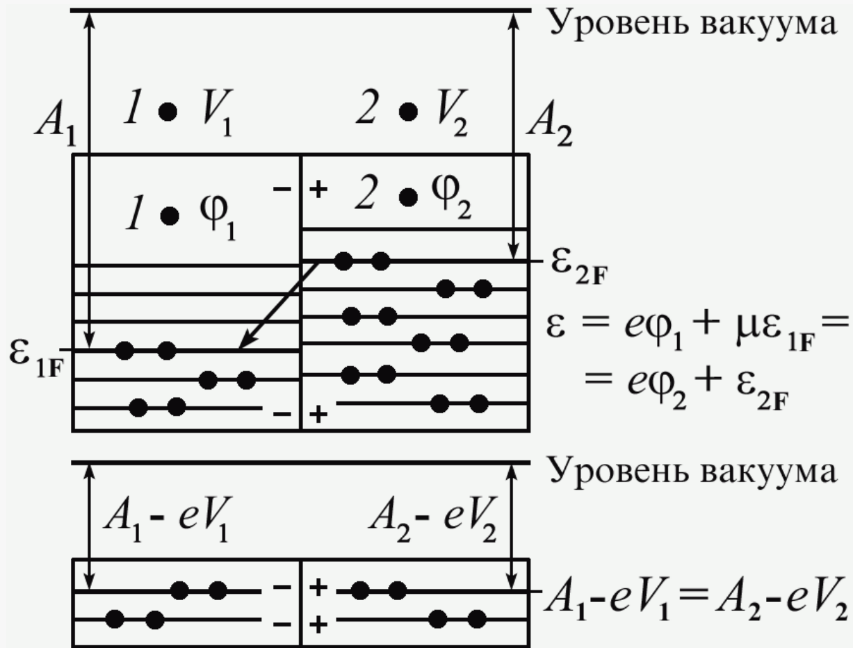
Рис. 2. Вычисление внешней V_2 - V_1 и внутренней \varphi_2 - \varphi_1 контактной разности потенциалов: \varepsilon_{1F} , \varepsilon_{2F} – положение уровней Ферми до контакта, \varepsilon_{1F} + e\varphi_1 = \varepsilon_{2F} + e\varphi_2 – уровень Ферми после соприкосновения выравнивается. A_1 = e\varphi_1 , A_2 = e\varphi_2 .
