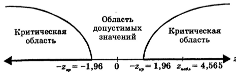
Рисунок 1 – Области принятия и отклонения нулевой гипотезы
