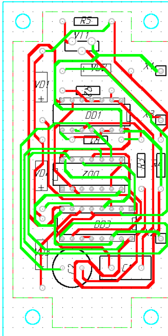
Рис. 15. Вид оттрассированной ПП
