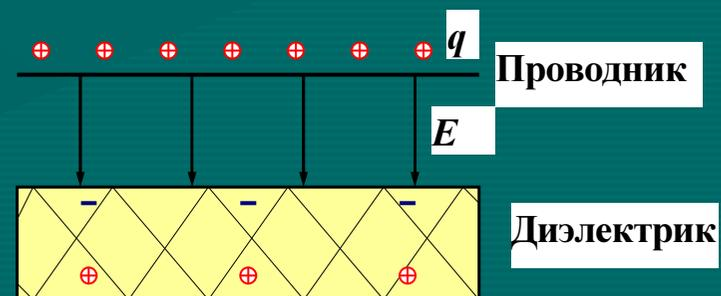
*Особенно большой емкостью обладает конденсатор – система из двух проводников, разделенных слоем диэлектрика, продольные размеры которых много больше расстояния между ними.*
