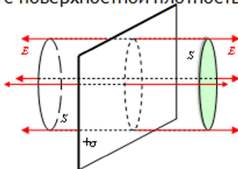
$$\Phi_E = \Phi_{E_{\text{лев}}} + \Phi_{E_{\text{прав}}} = 2 \int_{S_{\text{лев}}} \vec{E} d\vec{S} + \int_{S_{\text{прав}}} \vec{E} d\vec{S} = 2ES_{\text{лев}} + 0 (\leftarrow \vec{E} \perp d\vec{S}) = 2ES$$
