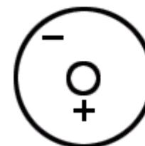
**2) полярные** – центры тяжести положительных и отрицательных зарядов в отсутствии внешнего электрического
