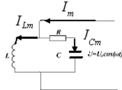
Поэтому явление резкого уменьшения амплитуды силы тока, питающего параллельно соединенные индуктивное и емкостное сопротивления, при приближении циклической частоты возбуждающей ЭДС к резонансной частоте получило название резонанса токов.
