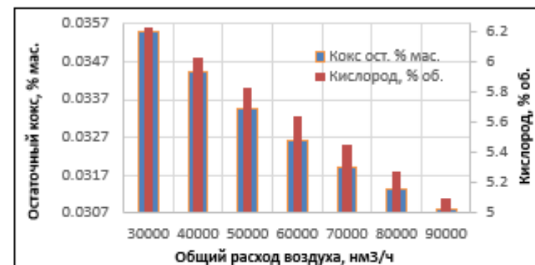
Зависимость содержания остаточного кокса и кислорода после регенерации от общего расхода воздуха
