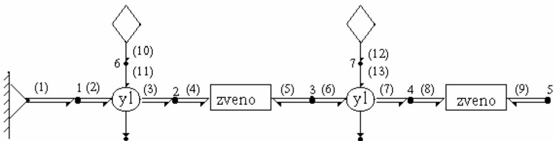
Рис. 2.36. Схема двухзвенного манипулятора
