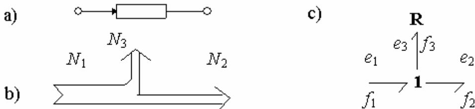
Рис. 2.5. Потоки мощности в резисторе:
