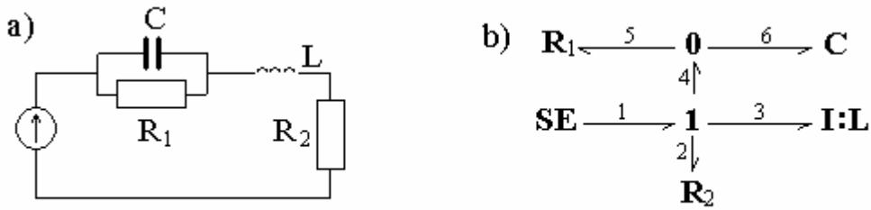
Рис. 2.21. Электрическая схема и ее граф
