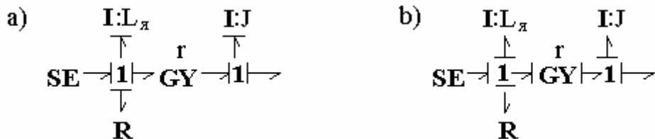
Рис. 2.24. Причинные отношения в графе связей двигателя постоянного тока:
