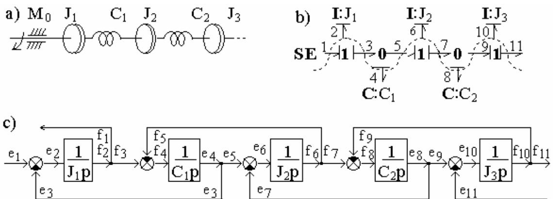
Рис. 2.26. Построение операторно-структурной схемы многомассовой механической системы с упругими связями:
