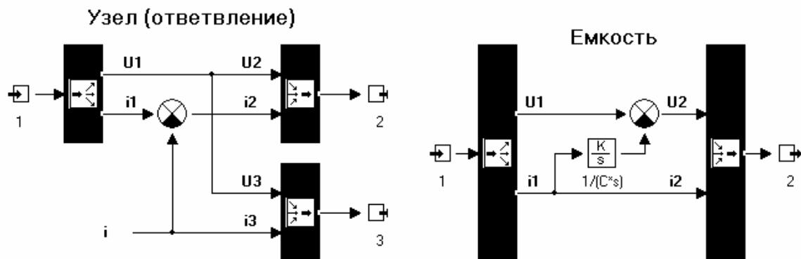
*Рис. 5.3. Эквивалентные схемы узла и емкости (макроблоки)*
