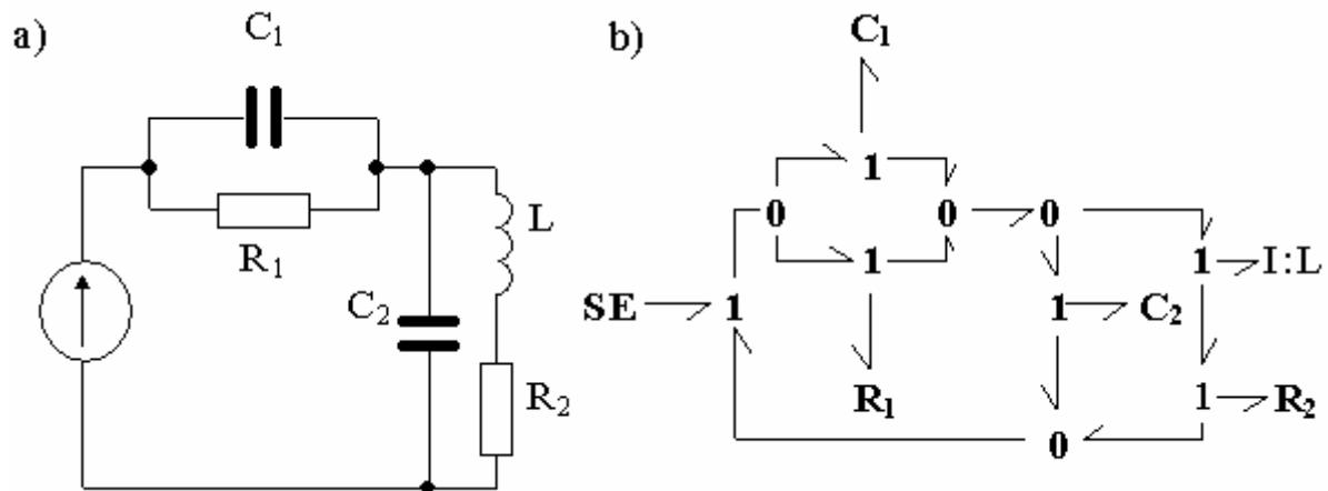
Рис. 2.7. Граф связей электрической цепи:
