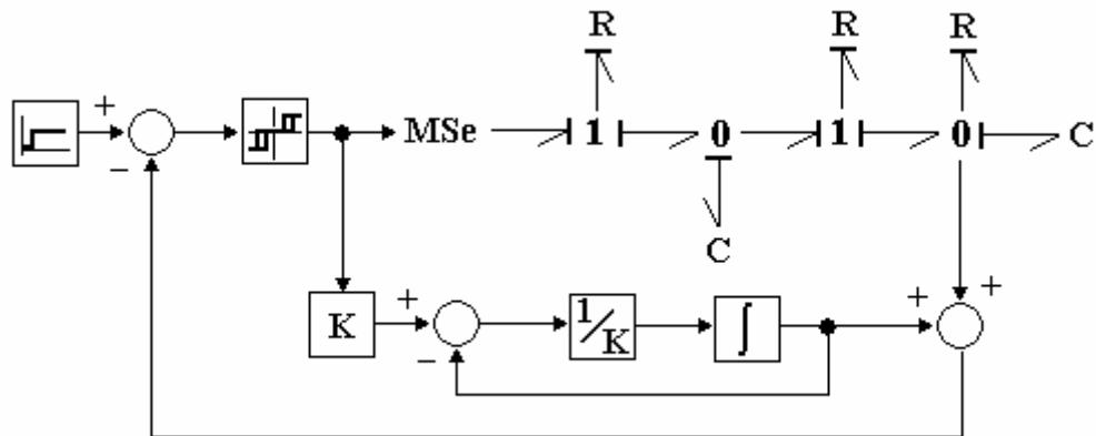
*Рис. 5.4. Схема системы в пакете 20-sim с использованием графов связей*
