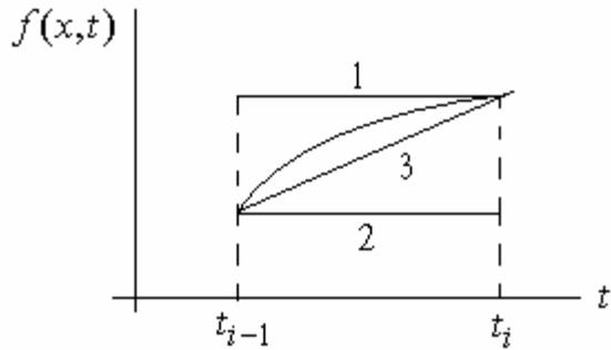
Рис. 3.3. Иллюстрация шага интегрирования
