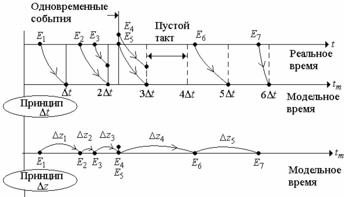
Рис. 3.1. Механизмы продвижения модельного времени
