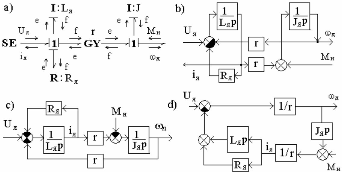
Рис. 2.25. Построение операторно-структурной схемы двигателя постоянного тока
