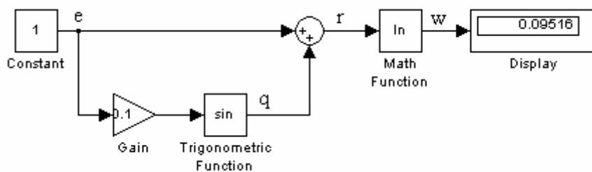
*Рис. 4.4. Статический информационный поток в пакете Simulink*
