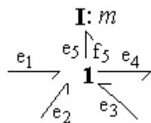
*Рис. 2.10. Графическая интерпретация принципа Даламбера*
