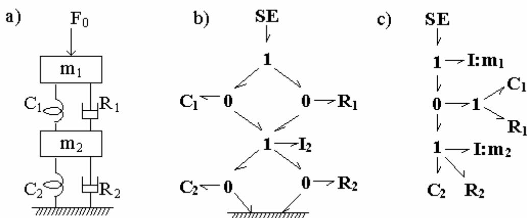
*Рис. 2.15. Механическая система с поступательным перемещением:
