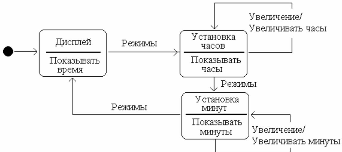
Рис. 3.4. Диаграмма состояний и переходов цифровых часов
