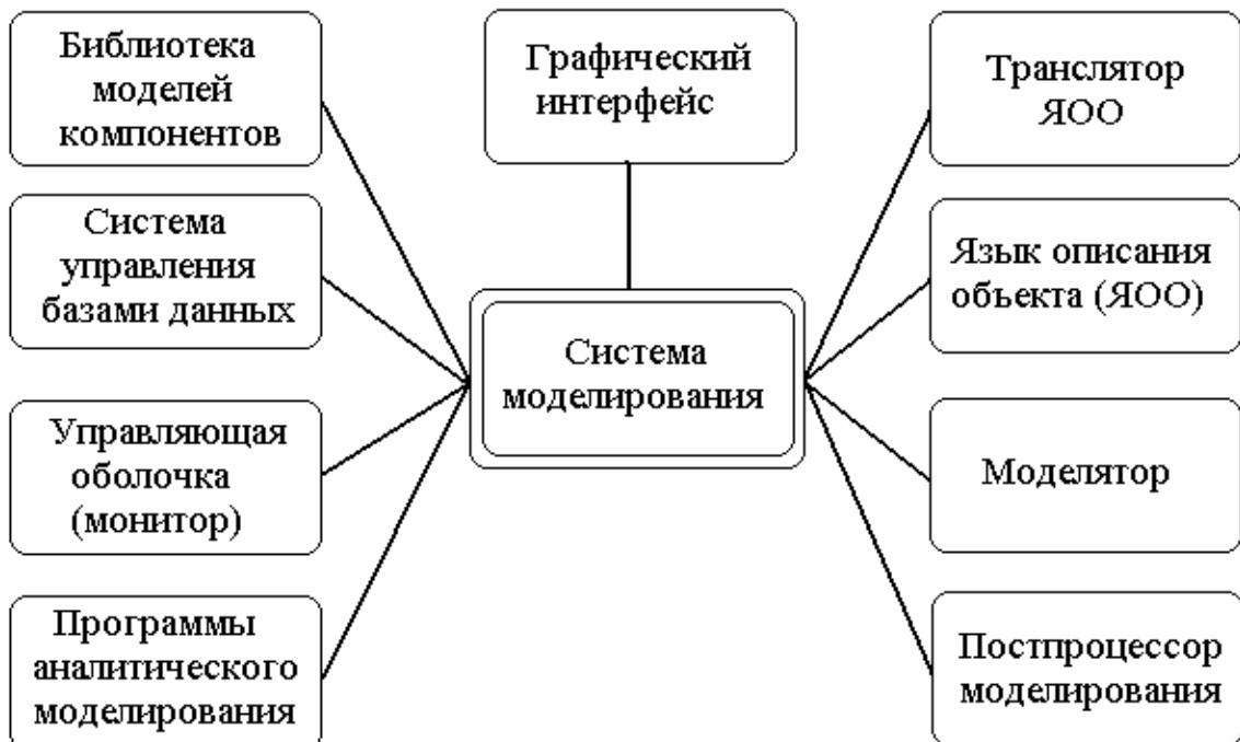
*Рис. 4.1. Модульная структура системы автоматизированного моделирования*
