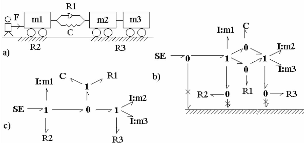
Рис. 2.14. Граф механической системы:
