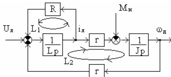
Рис. 2.27. Применение правила циклов к операторно-структурной схеме
