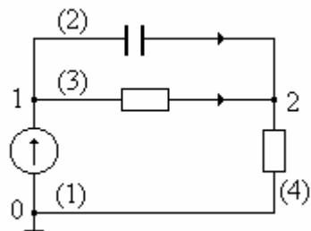
Рис. 2.33. Простая электрическая схема с энергетическими связями
