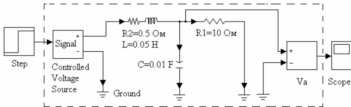
Рис. 5.6. Схема моделирования электрической цепи в пакете SimPowerSystems
