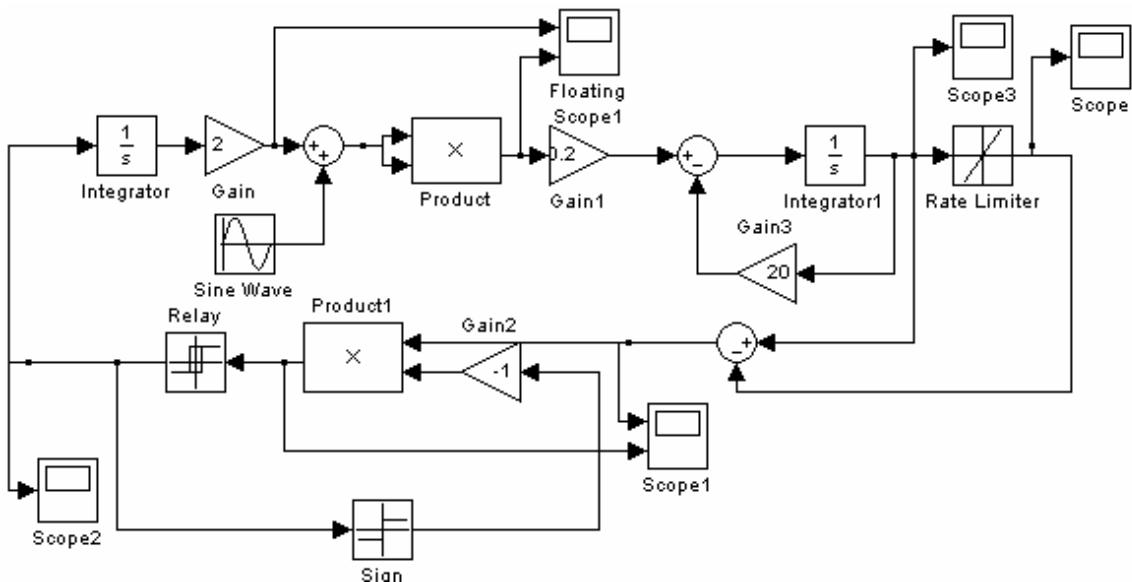
Рис. 4.2. Схема для структурного моделирования экстремальной системы в пакете Simulink
