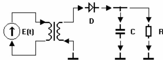
*Рис. 5.2. Пример построения модели электрической схемы выпрямителя в пакете MBTU*
