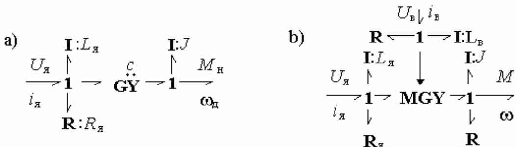
*Рис. 2.20. Граф связей двигателя постоянного тока:
