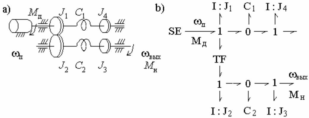
Рис. 2.17. Механическая вращающаяся система:
