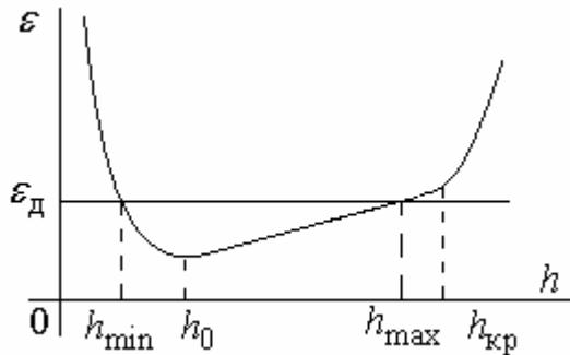
*Рис. 3.2. Зависимость ошибки интегрирования от величины шага интегрирования*
