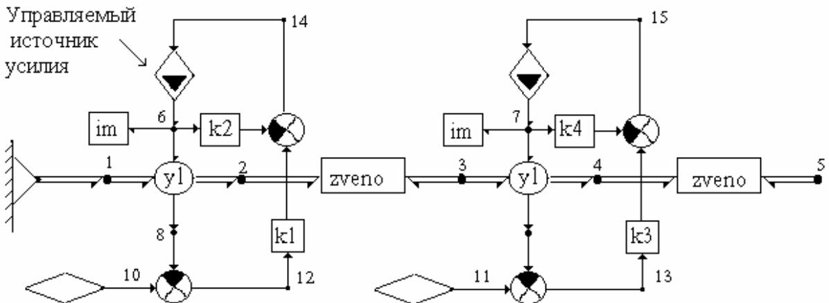
Рис. 2.37. Схема двухзвенного управляемого манипулятора
