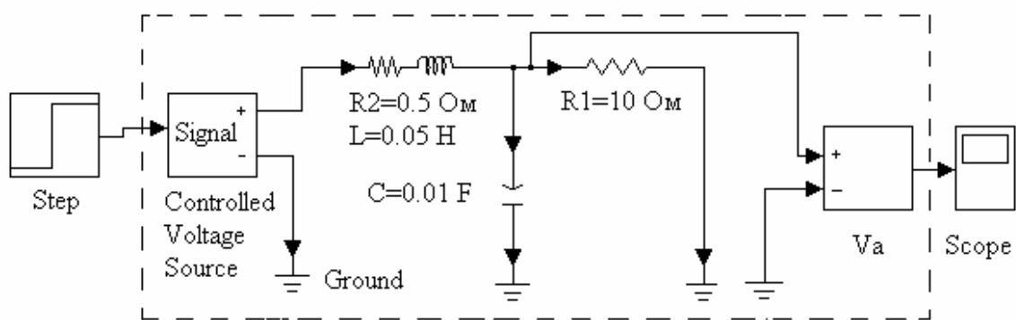
Рис. 4.3. Схема моделирования электрической цепи в пакете SimPowerSystems
