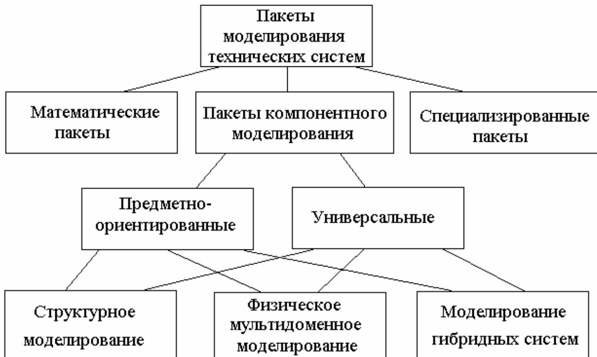
*Рис. 5.1. Классификация пакетов моделирования технических систем*
