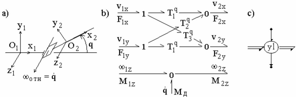
Рис. 2.35. Модель вращательной кинематической пары:
