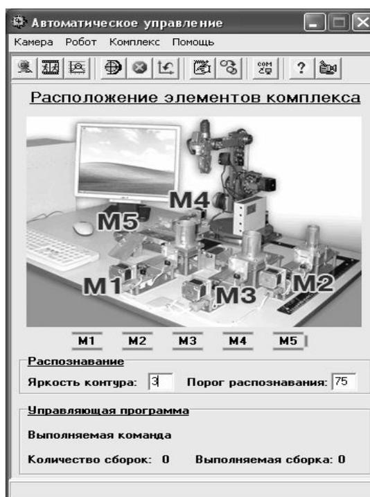
Рис. 10. Окно управления установкой в автоматическом режиме
