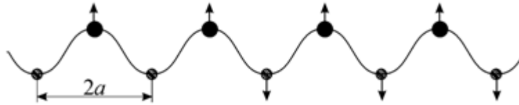
Рис. 5.9. При малых значениях волнового числа k атомы разного сорта колеблются в противофазе
