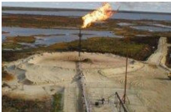
Газ **2 – ой** ступени сепарации, наиболее богатый тяжелыми углеводородами и поэтому являющийся ценным химическим сырьем, продолжает сжигаться на факелах.
