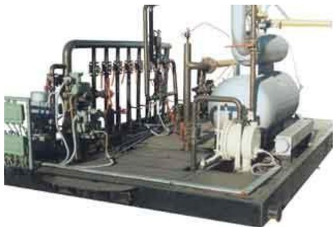
Установки предназначены для автоматического определения дебитов нефтяных скважин по жидкости и контроля за работой скважин.
