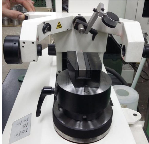
Рис. 5. Подвод камеры прибора к режущей кромке.
