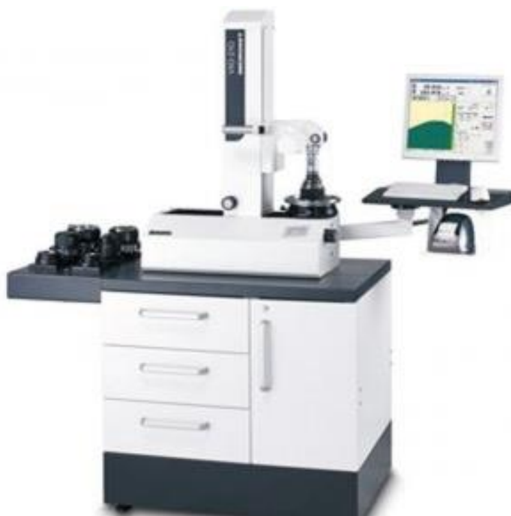
Рис. 1. Измерительный прибор DMG Microset серии VIO 210.
