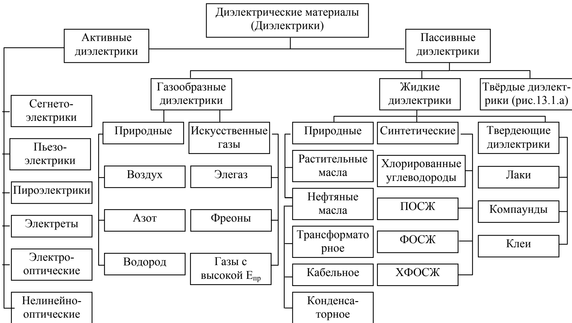
Рис.13.1. Классификация диэлектрических материалов. (ПОСЖ – полиоргсилоксановые жидкости; ФОСЖ – фторорганические жидкости; ХФОСЖ - хлорфторорганические жидкости).
