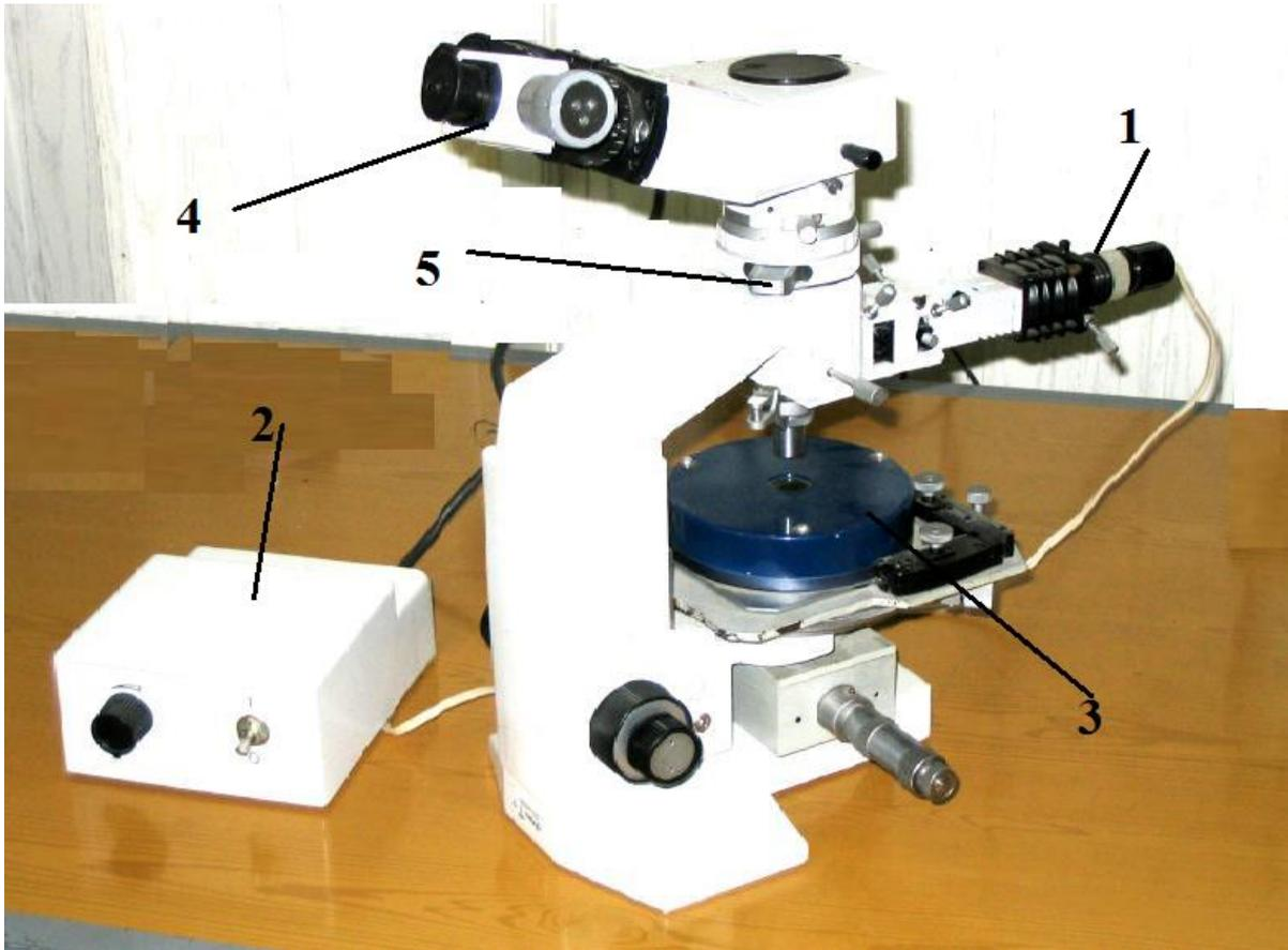
Экспериментальная установка: 1 – осветитель, 2 – блок питания осветителя, 3 – ячейка для получения колец Ньютона, 4 – окуляр микроскопа снабжен шкалой и микрометрическим винтом, 5 – набор светофильтров.
