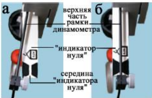
Рис. 6 Положение верхней части рамки динамометра относительно середины «индикатора нуля» (вид сверху) (а)–рамка смещена, (б)–рамка установлена точно посередине «индикатора нуля»
