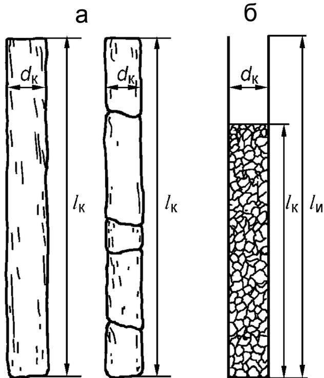
Образцы получаемого керна при бурении различных пород
