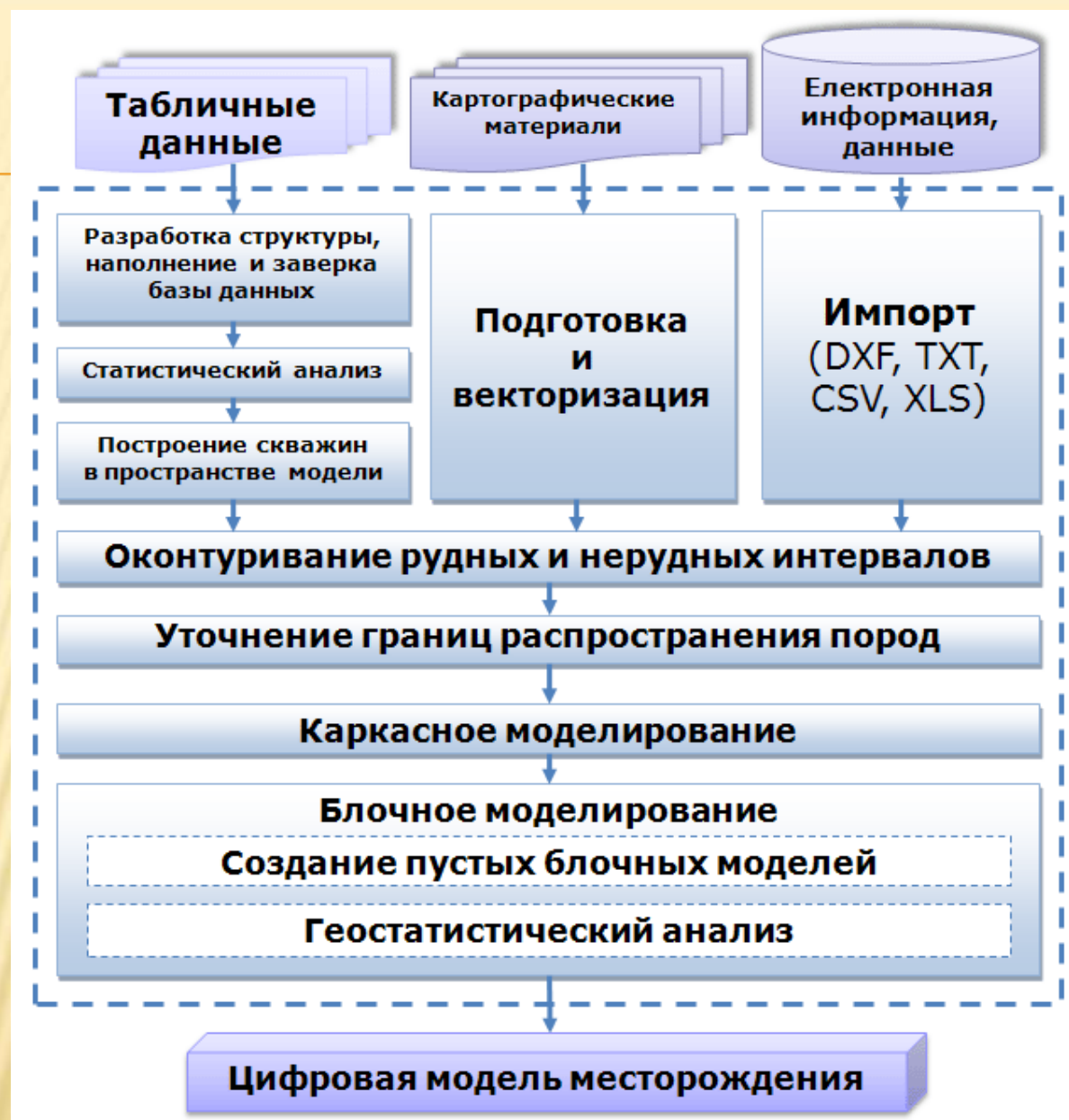
Схема формирования цифровых моделей месторождений с использованием ГИС K-MINE
