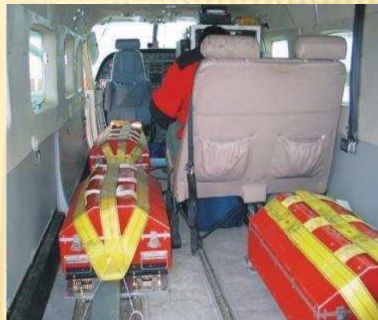
Размещение контейнеров с датчиками радиоактивности в кабине самолета. Объем кристаллов-датчиков >25 л.
