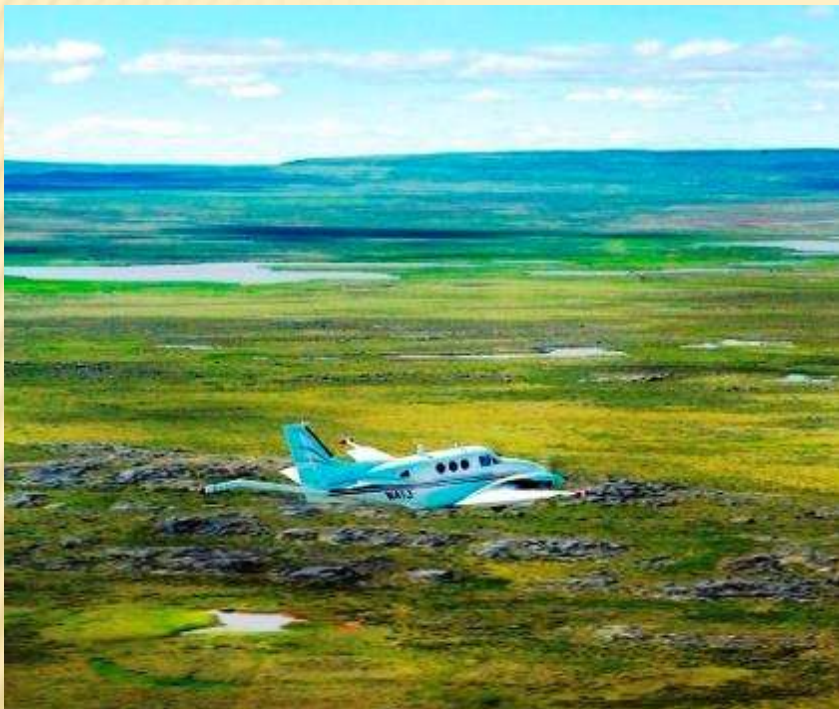
АГСМ – съемка и поиски урана в Канаде. Самолет Сессна. Высота полета <70 м. Магнитный датчик на консоли за хвостом самолета.
