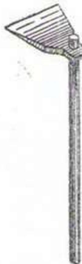
Рис. 10. Железный гребок для перемешивания материала пробы
