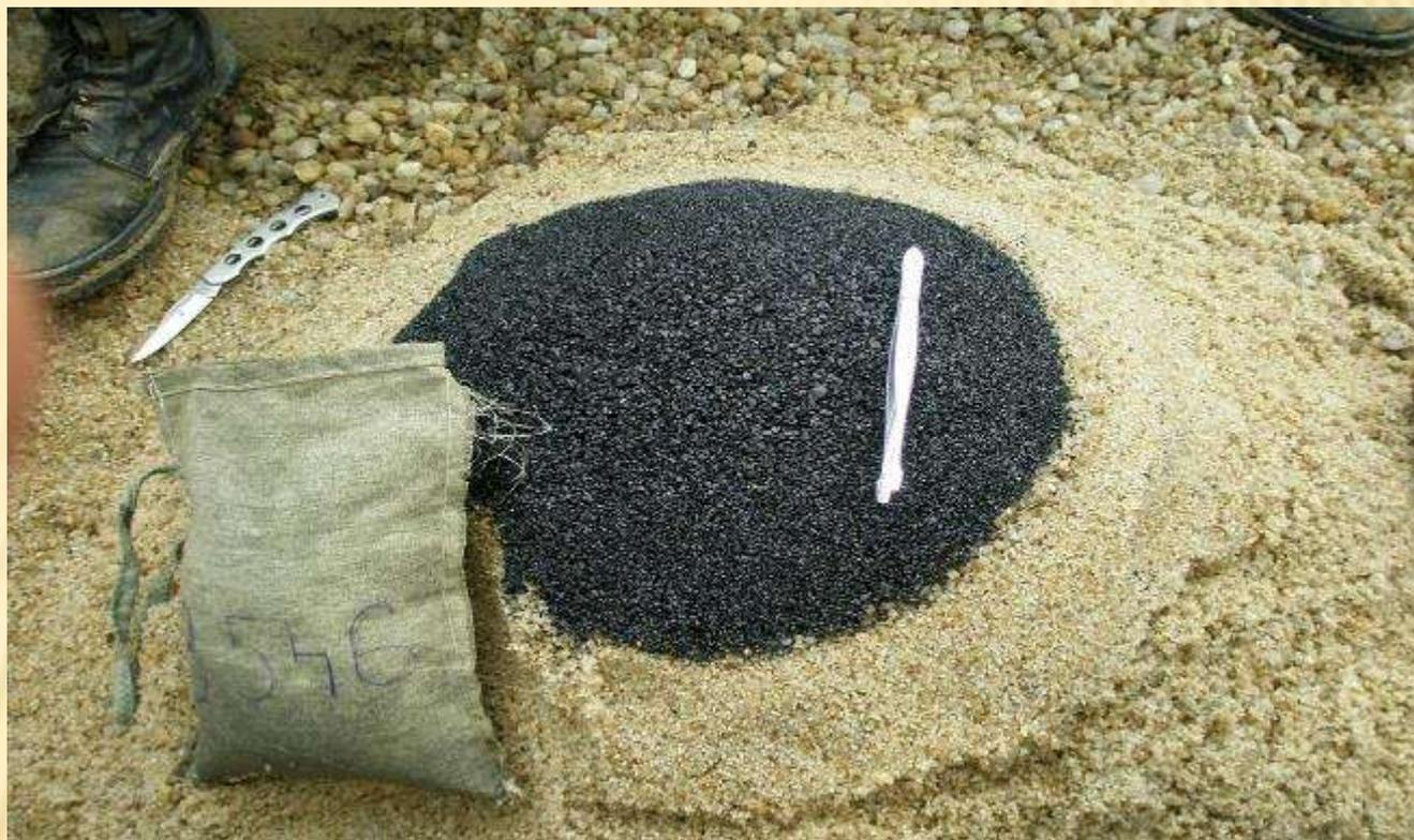
Класс  $-8+4$  мм просматривается визуально для отбора крупных зерен минералов-спутников и алмазов. Классы  $-4+2$  мм;  $-2+1$  мм ( $-2+0,5$  мм) подвергаются обогащению на ручных отсадочных машинах. Материал класса  $-1$ мм ( $-0,5$ мм) частично (40-50 л), промывается в лотке до "серого" шлиха.
