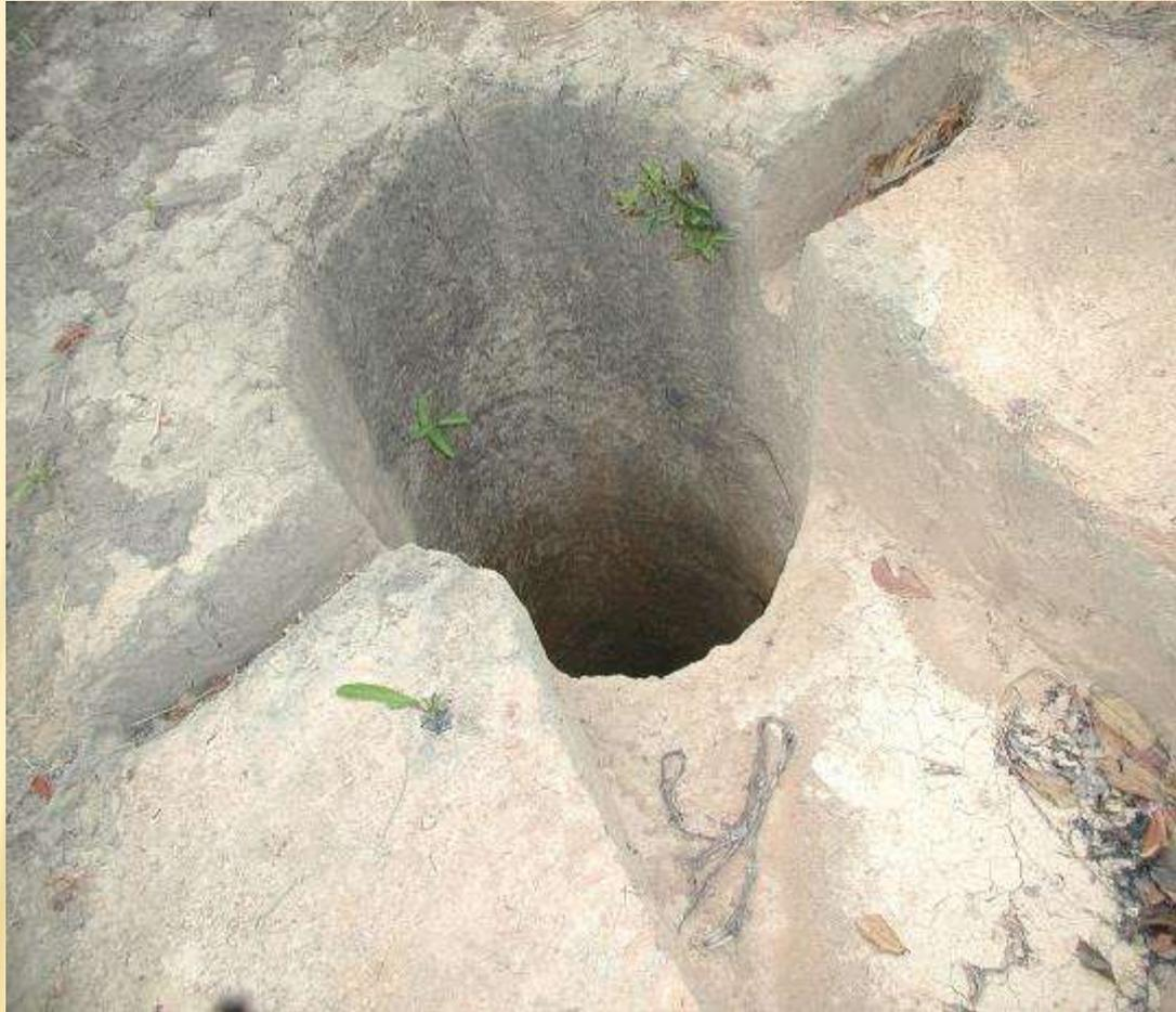
Наработка крупнообъемных проб осуществляется из поверхностных горных выработок (шурфов, канав и т.п.), пройденных с использованием средств механизации.
