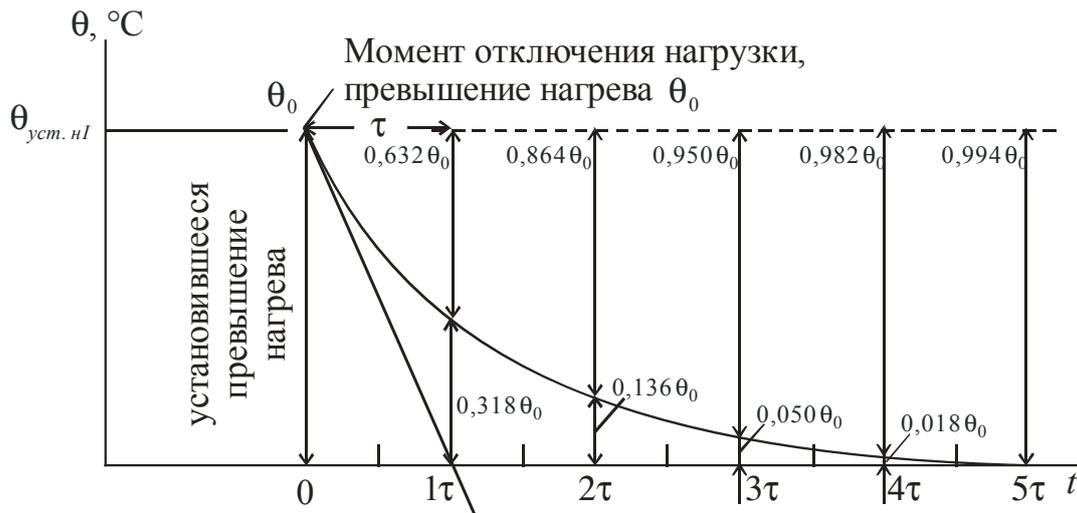
Рис. 2.2. Изменение превышения нагрева проводника после отключения нагрузки
