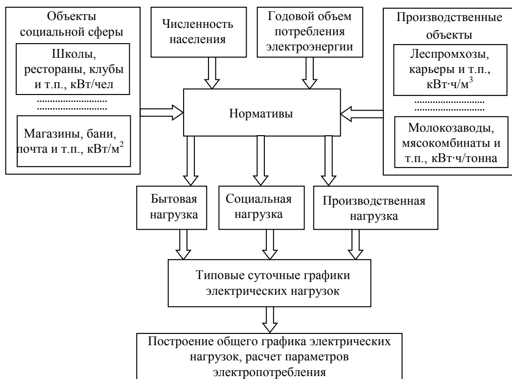
Рис.3.1. Схема расчета прогнозных режимов потребления электрической энергии автономной системой электроснабжения
