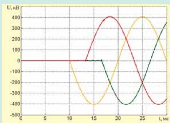
Рис. 4. Осциллограммы напряжений при включении фаз реактора в моменты нулевых значений напряжения
