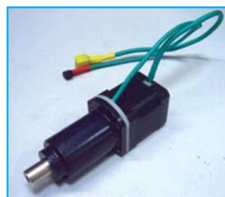
Рис. 5. Внешний вид привода рабочего органа топливного насоса
