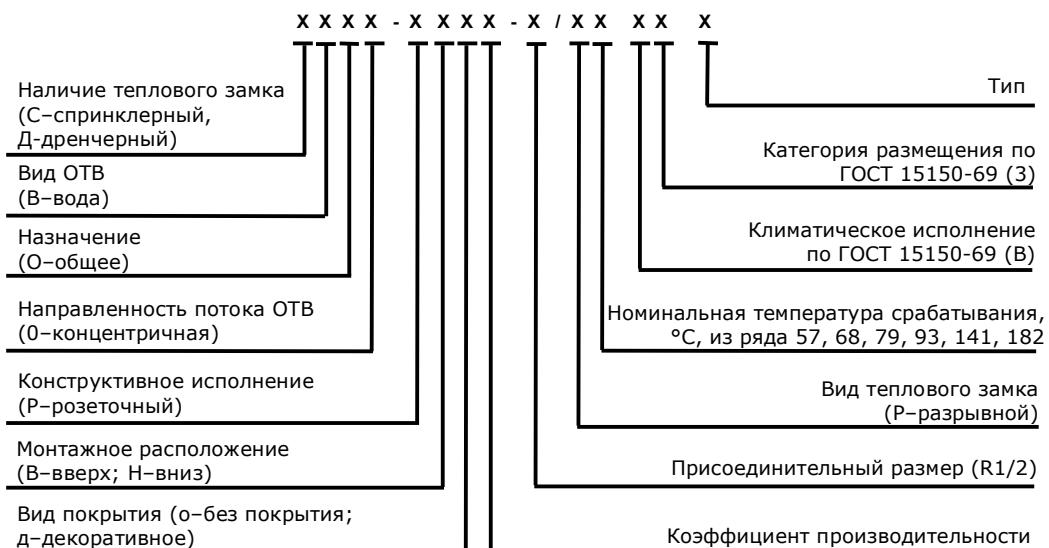
**Обозначение и маркировка спринклерных оросителей по ГОСТ Р 51043-2002**
