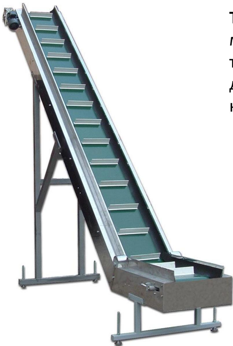
**Транспортер (конвейер)** - машина непрерывного транспорта, предназначенная для перемещения сыпучих, кусковых или штучных грузов.
