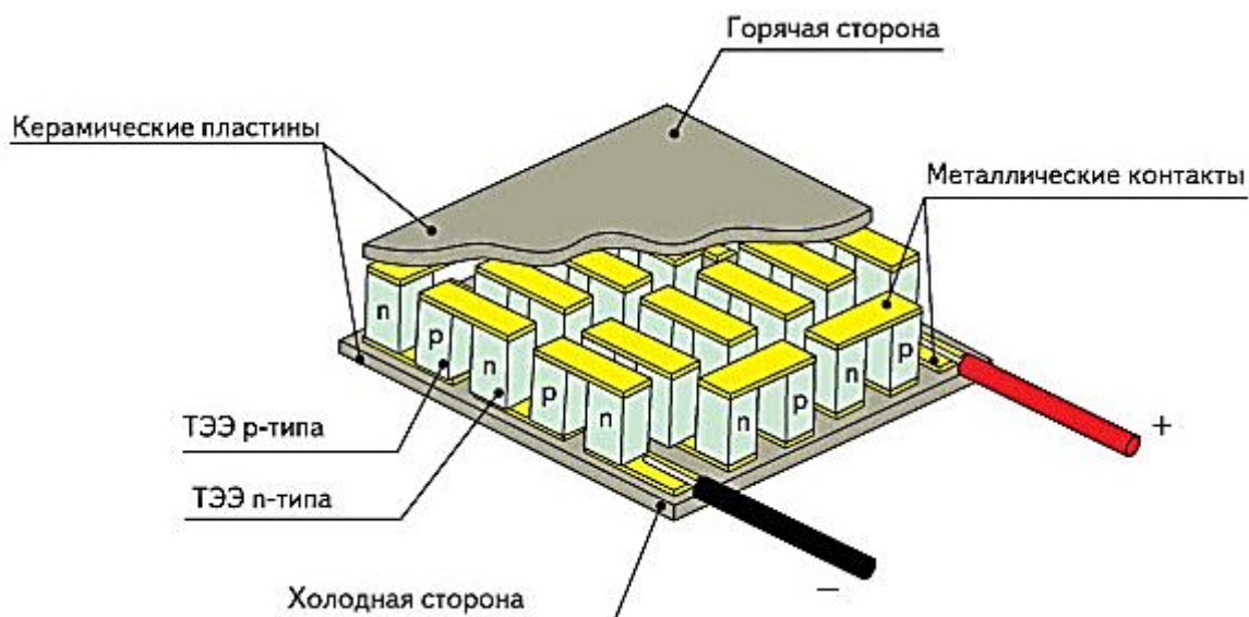
Рис. 12.2. Принципиальная схема работы ТЭГ ( https://clck.ru/XkoUZ )
