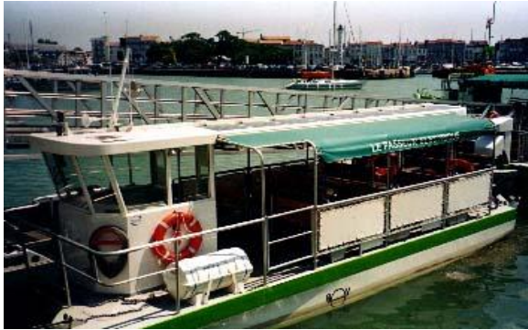
Le passeur électrique à La Rochelle - une partie de l'énergie est fournie par les panneaux solaires sur le toit du bateau
