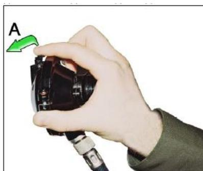
Рис. 9. Способ перекрытия легочного автомата при проверке звукового сигнализатора
