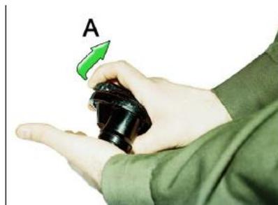
Рис. 8. Способ перекрытия легочного автомата при проверке звукового сигнализатора
