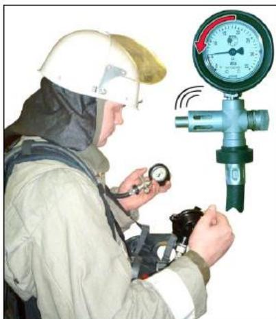
Рис. 10. Проверка срабатывания звукового сигнализатора
