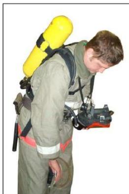
Рис. 13. Подготовка к включению в дыхательный аппарат
