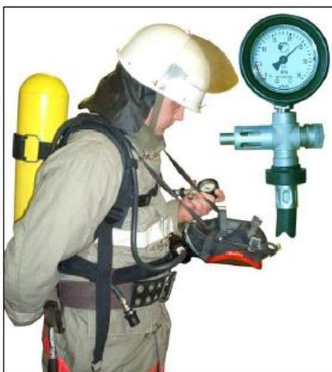
Рис. 12. Проверка давления в баллоне
