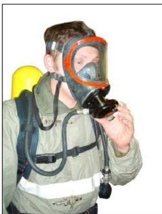
Рис. 6. Выключение легочного автомата
