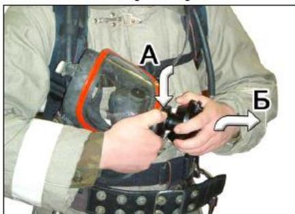
Рис. 7. Отсоединение легочного автомата
