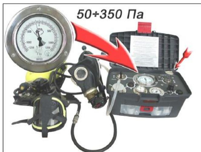
**Рис. 8.** Проверка исправности легочного автомата спасательного устройства
