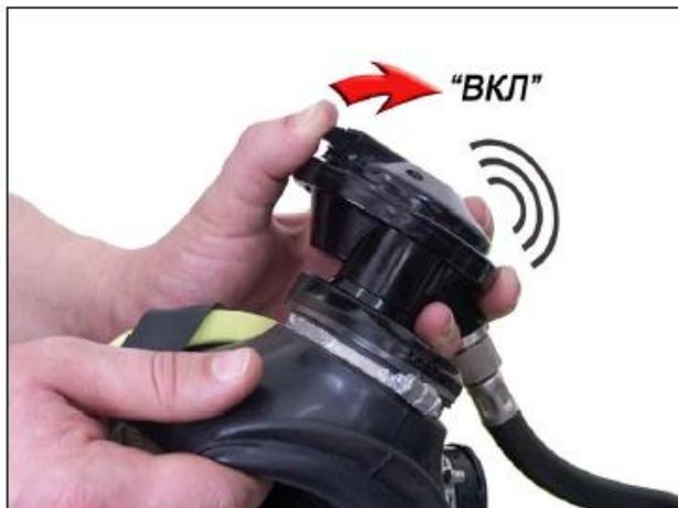
Рис. 9. Проверка устройства дополнительной подачи воздуха
