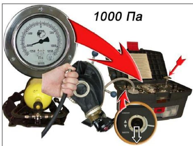
**Рис. 6.** Проверка герметичности воздуховодной системы спасательного устройства
