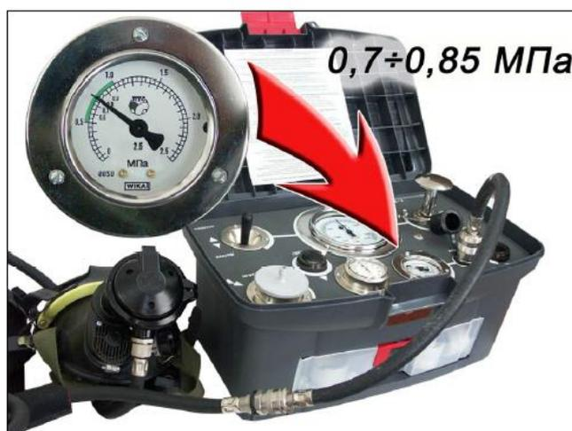
Рис. 10. Проверка исправности газового редуктора
