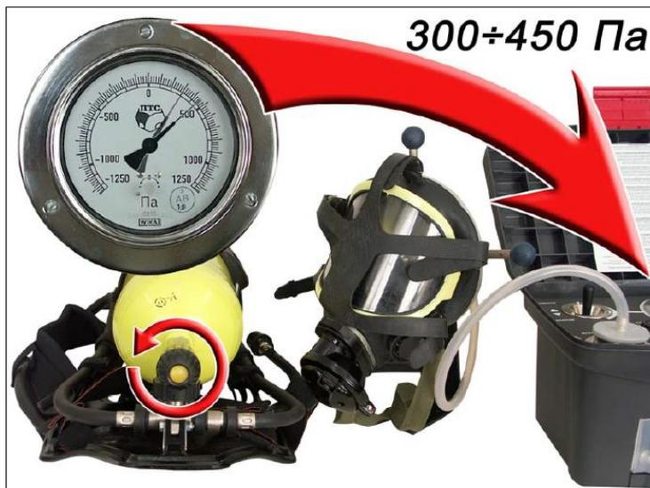
Рис. 1. Проверка механизма подмасочного давления
