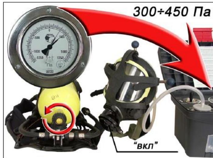
**Рис. 7.** Проверка исправности легочного автомата газодымозащитника
