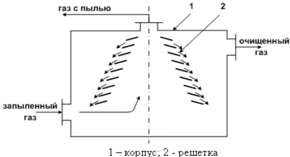
Максимальное содержание пыли  $0,02 \text{ кг/м}^3$ , размер улавливаемых частиц  $20 \dots 50 \text{ мкм}$ , механизм осаждения инерционный, эффективность  $60\%$ , достоинства - простота изготовления и эксплуатации, нет движущихся частей, недостатки - износ пластин при высокой концентрации пыли, большое гидравлическое сопротивление – около  $500 \text{ Па}$ .
