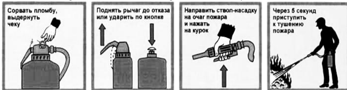
Рис. 66. Приведение в действие порошкового огнетушителя со встроенным источником давления
