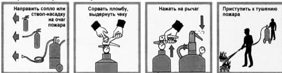
Рис. 65. Приведение в действие порошкового огнетушителя закачного
