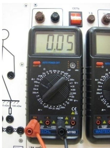
Рис. 40. Подключение мультиметра для измерения тока
