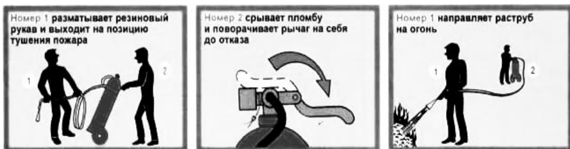
Рис. 61. Приведение в действие передвижного углекислотного огнетушителя
