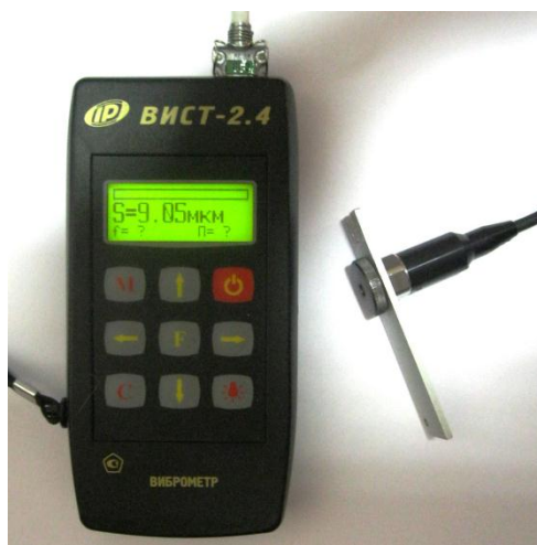
Рис. 25. Измеритель шума и вибрации ВИСТ-2.4 с вибродатчиком, закрепленном на алюминиевой пластине
