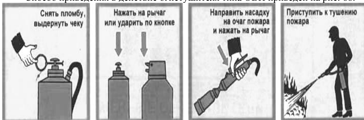
Рис. 68. Приведение в действие воздушно-пенного огнетушителя
