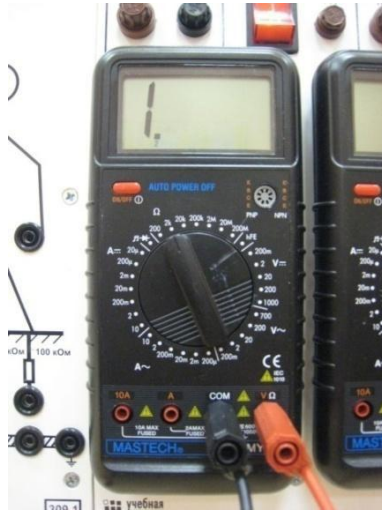
Рис. 39. Подключение мультиметра для измерения сопротивления
