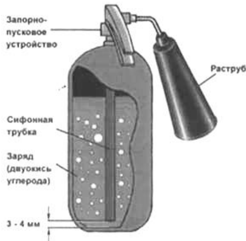
Рис. 59. Конструкция углекислотного огнетушителя
