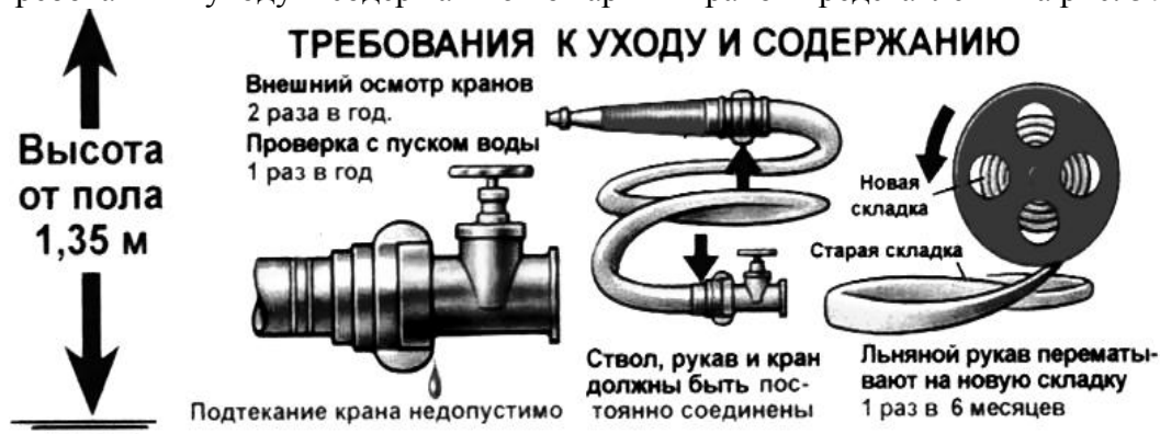
Рис. 57. Требования к уходу и содержанию пожарных кранов
