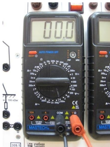
Рис. 38. Подключение мультиметра для измерения напряжения
