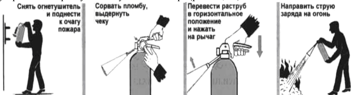
Рис. 60. Приведение в действие ручного углекислотного огнетушителя
