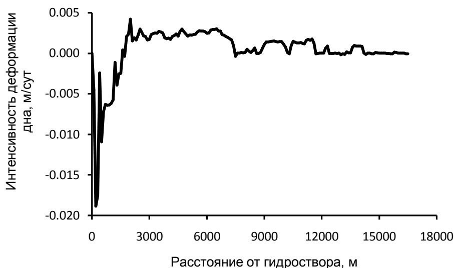
Рис. 3.4.2.5. Изменение средней по сечению интенсивности деформаций дна р. Томи на участке 74,8...58,3 км от устья; Q=6860 \text{ м}^3/\text{с}
