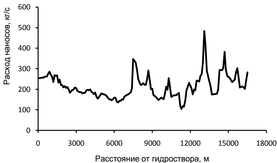
Рис. 3.4.2.3. Изменение суммарных расходов наносов р. Томи на участке 74,8...58,3 км от устья (гидроствор – устье р. Большой Киргизки); Q=6860 \text{ м}^3/\text{с}
