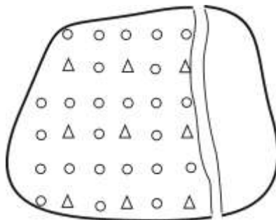
Рис. 3.13. Девятиточечная система внутриконтурного заводнения
