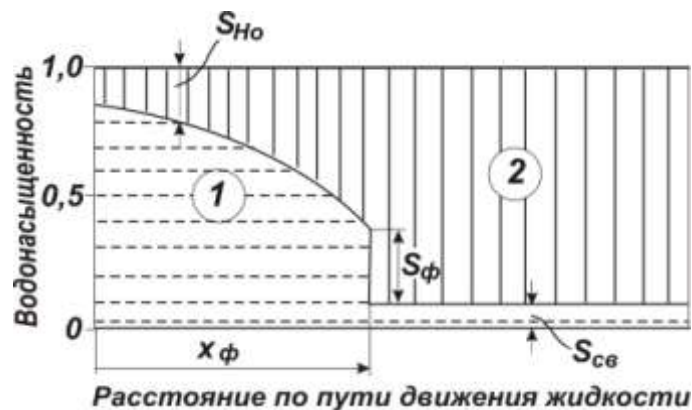
Рис. 4.3. Модель непоршневого вытеснения нефти водой. Насыщенность: 1 – водой; 2 – нефтью
