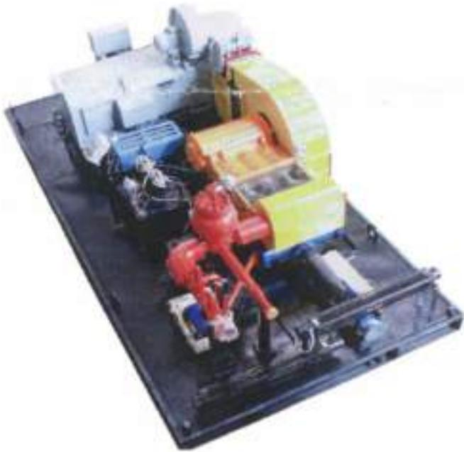
*Рис. 115. Буровой насосный агрегат (насос + приводной электродвигатель постоянного тока) с трёхплужерным насосом СИН-6*
