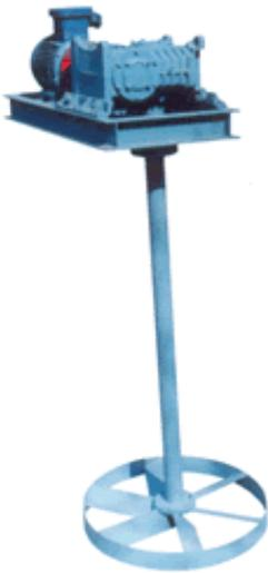
*Рис. 100. Перемешиватель лопастной ЦСЗ-3000 ЭУК-03.15*
