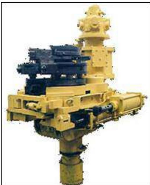
*Рис. 75. Автоматический буровой стационарный ключ АКБ-4*
