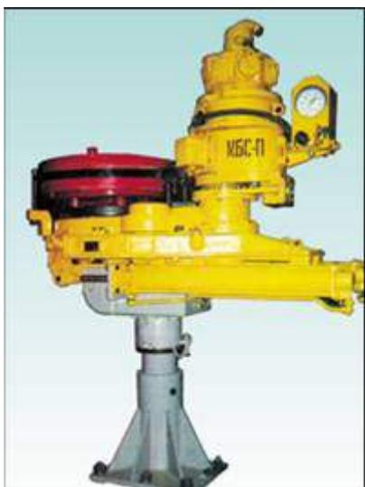
*Рис. 76. Внешний вид бурового автоматического стационарного пневмоприводного ключа КБС-П*
