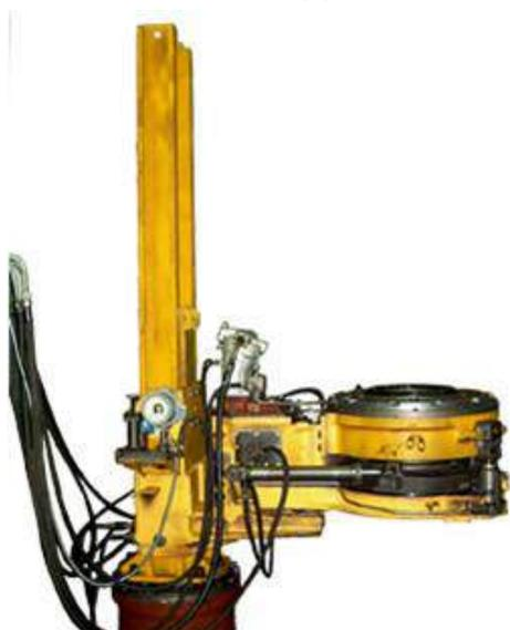
*Рис. 77. Ключ буровой автоматический стационарный с гидроприводом*
