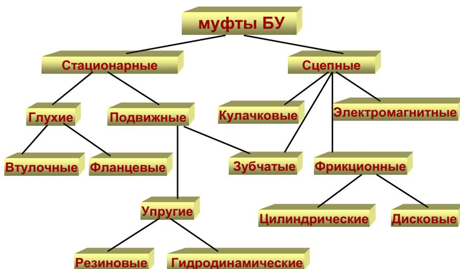
Рис. 28. Классификация муфт по конструкции
