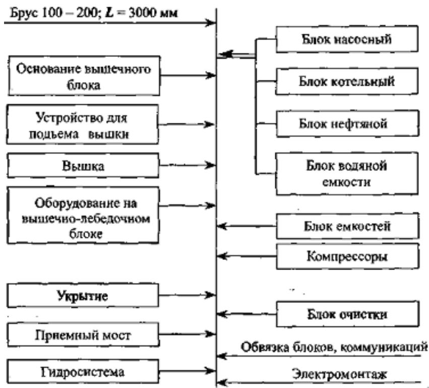
Рис. 164. Схема пооперационной сборки кустовой буровой установки
