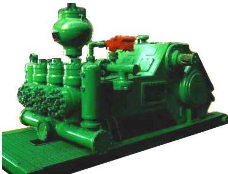
*Рис. 114. Трехпоршневой буровой насос УНБТ-950А*
