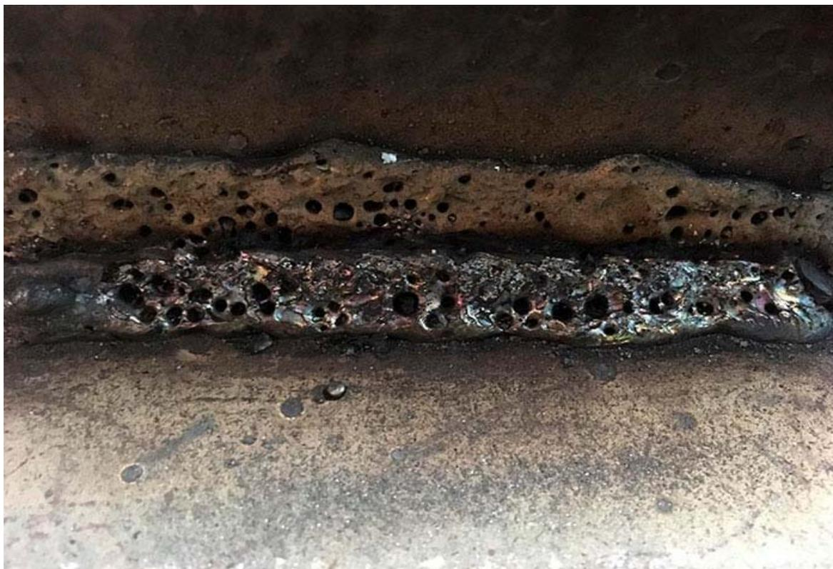
*Рис. 10.2 Разрез сварного шва с макро- и микродефектами*
