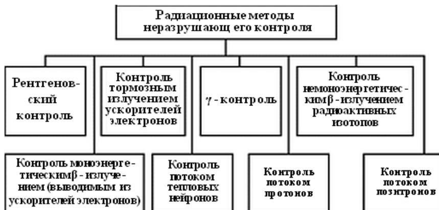
Рис. 4.5. Классификация радиационных методов неразрушающего контроля
