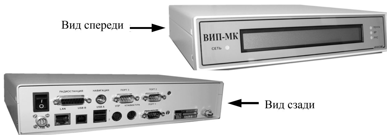
Рис. 4. Многофункциональный микропроцессорный терминал ВИП-МК
