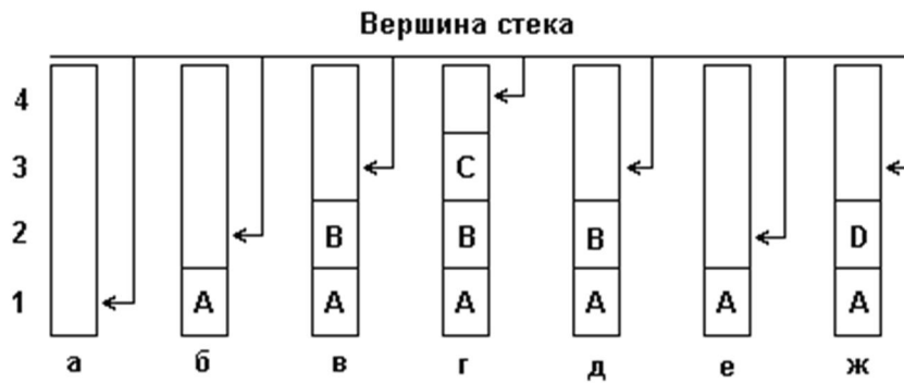
Рис. 4. Включение и исключение элементов из стека
