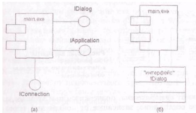
Другим способом представления интерфейса на диаграмме компонентов является его изображение в виде прямоугольника класса со стереотипом "интерфейс" и возможными секциями атрибутов и операций (см. рис.). Этот вариант обозначения используется для представления внутренней структуры интерфейса, которая может быть важна для реализации.
