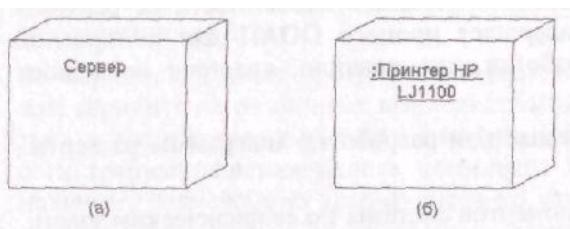
Изображения узлов могут расширяться, чтобы включить некоторую дополнительную информацию о спецификации узла.
